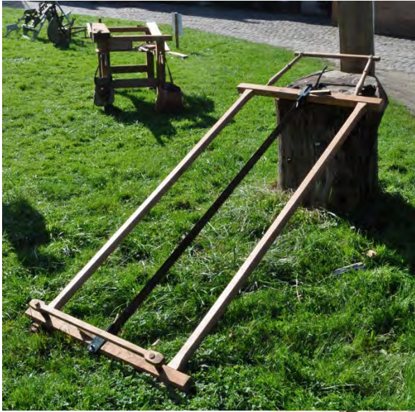
Het oude raamzaagtype, zoals het in Frankrijk tot het einde van het berdzagtijdperk in voege bleef. MOT (Grimbergen), 2015
