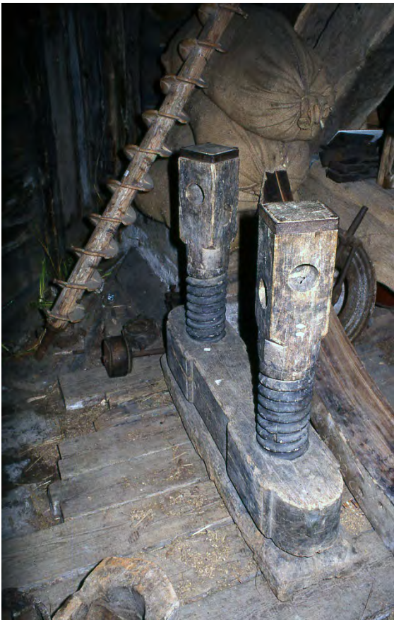
Blokvijzel met sporen van bruine zeep met grafietpoeder
