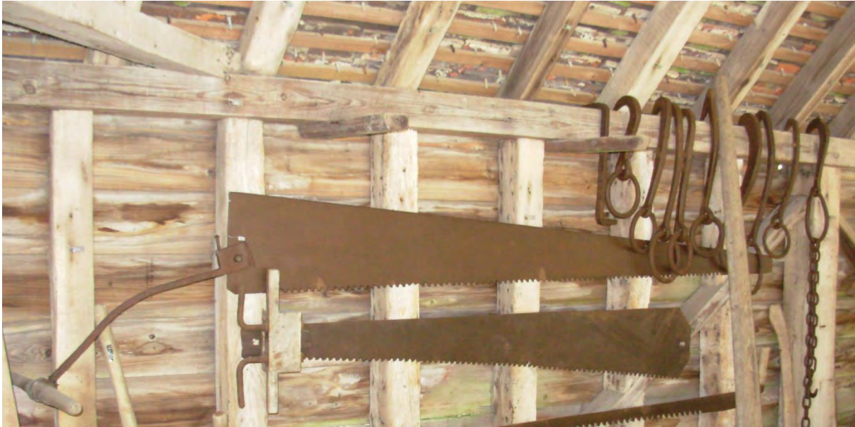
Een reeks kantelhaken en twee berdzagen. Deze zagen hebben een vertanding om te schulpen (in de lengte zagen). Weald and downland museum UK, 2010.
