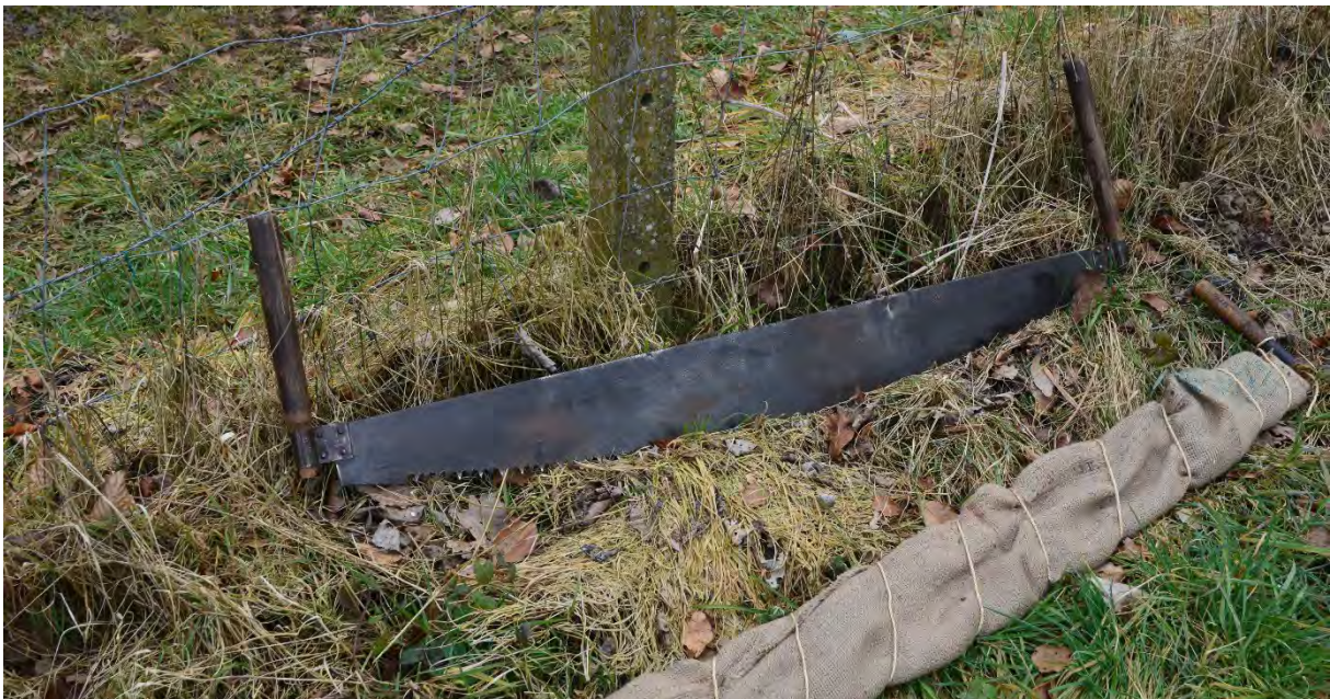
Afkortzaag met gewone afkort vertanding. Opname van de film "Klompenhout" in 2015.
