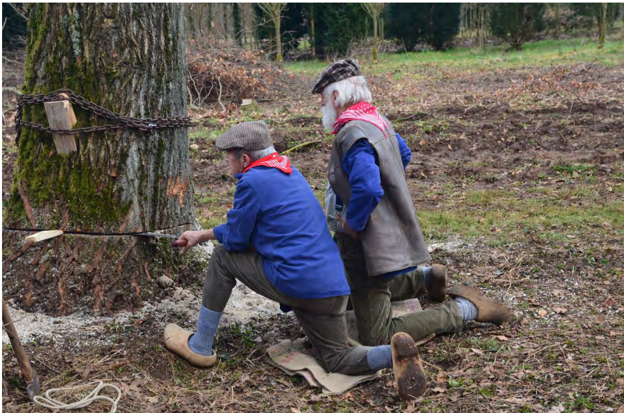
Achter de zaagsnede werd er een spie geslagen tegen het klemmen van de zaag. Opname van de film "Klompenhout" in 2015. Foto: Paul Van Herck
