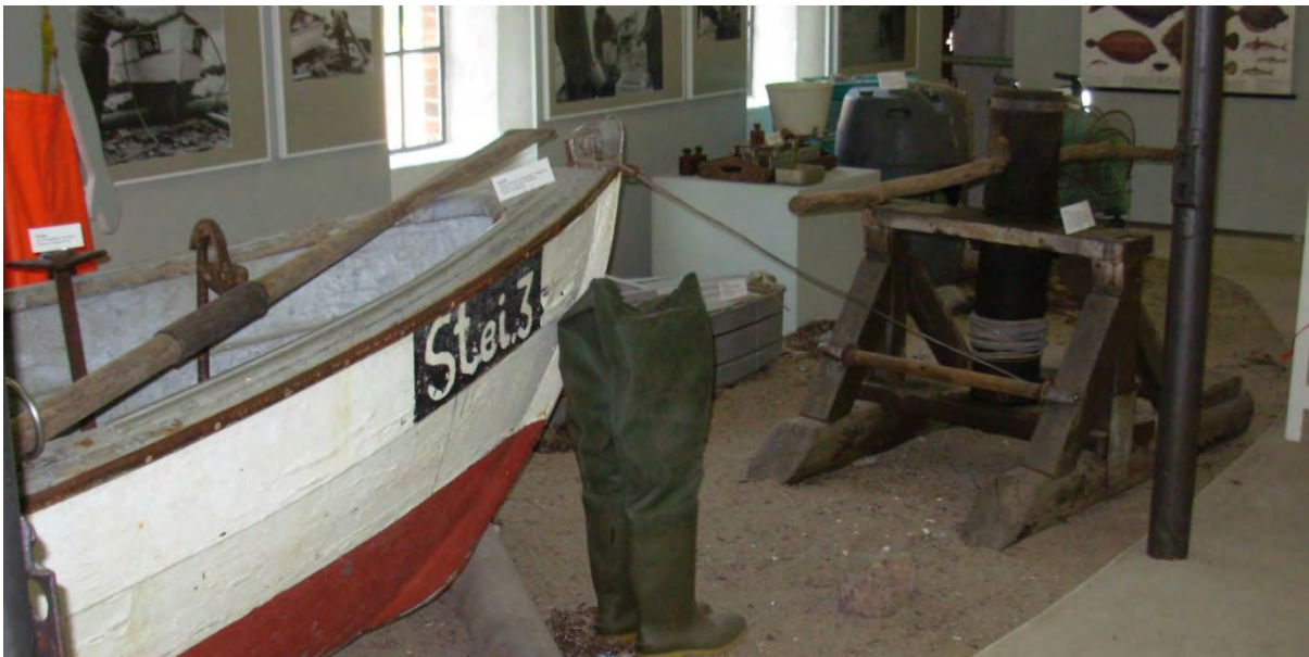
Visserssloop en bijhorende kaapstander om hem op het droge te trekken. Museum Christesenscheune-Unewatt, 2007
