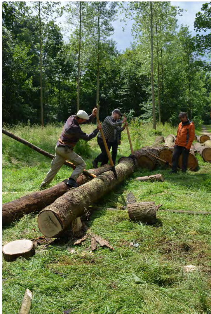
Het kantelen van een eik met twee peaveys in Boechout Foto: Danny Huyghens, 2017
