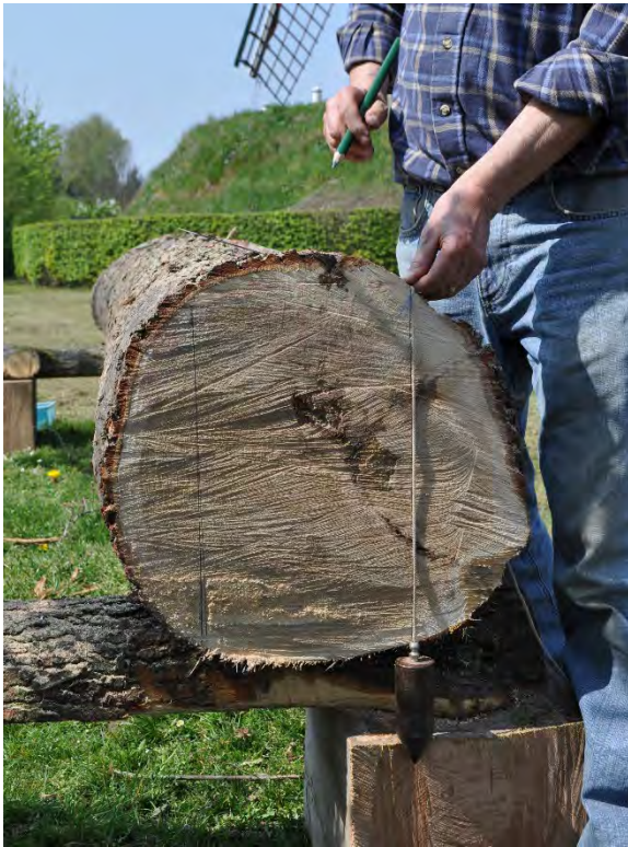
Afschrijven van de balkvorm op de koppen met schietlood vouwmetr en winkelhaak. Ontschorsen van de stam ter hoogte van de smetlijn.
