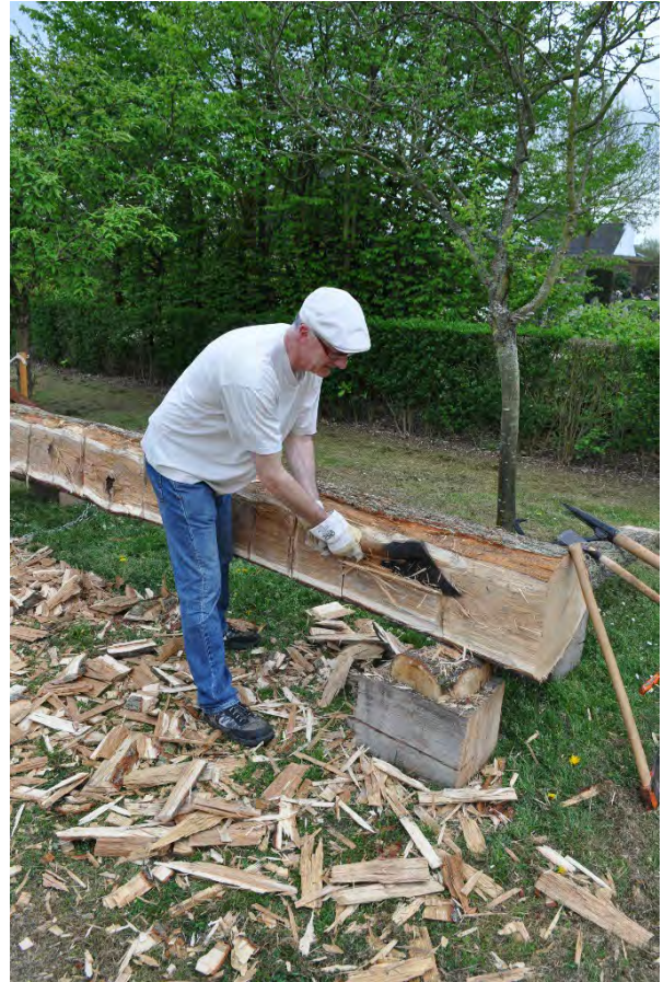
Afwerken van de zijkant met een Duitse beslagbijl of breedbijl (exemplaar voor rechtshandige). Foto's: Danny Huyghens, 2015
