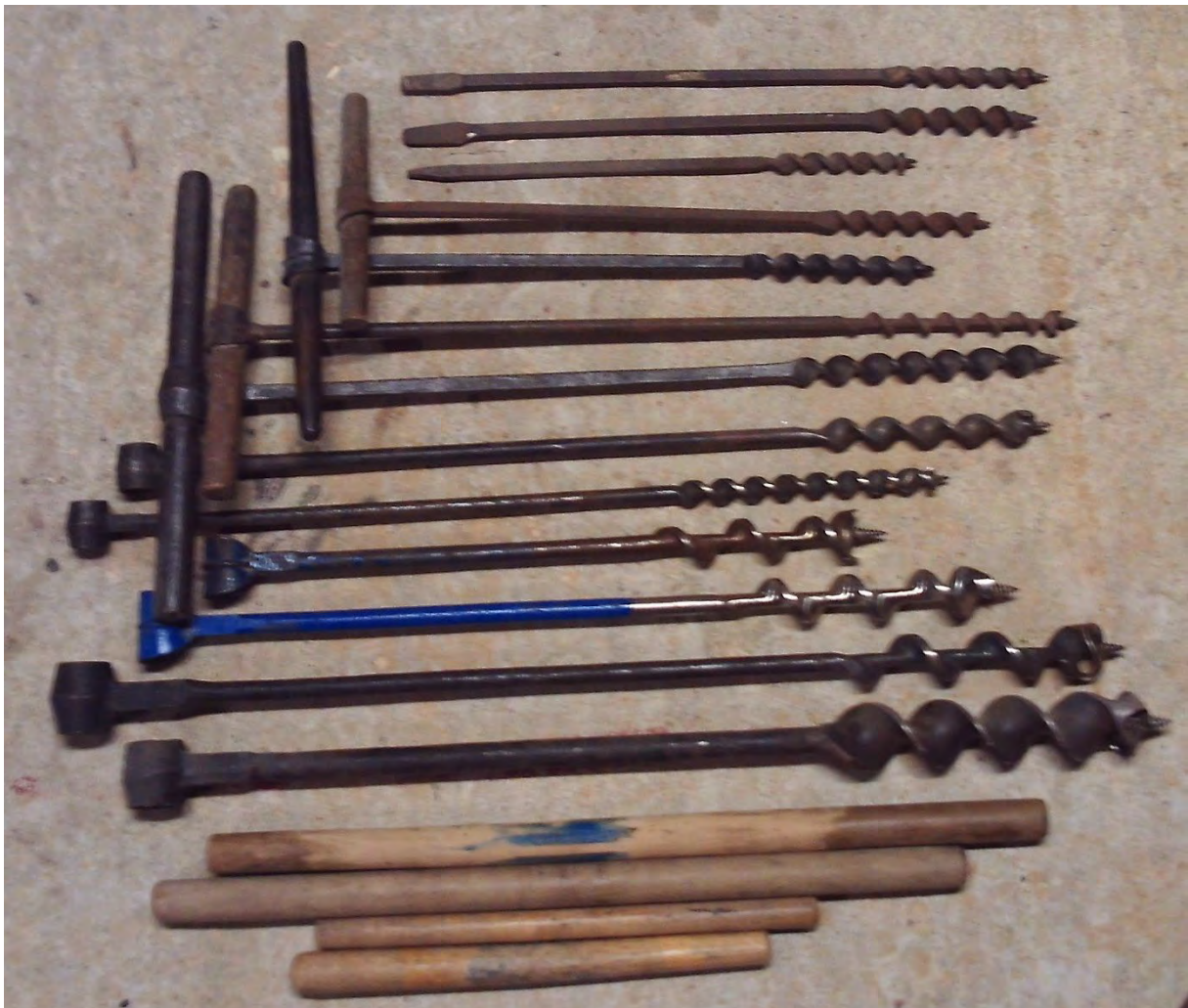
Avegaren, zowel exemplaren die op een plat vlak eindigen ter hoogte van het dwars handvat als exemplaren die op een oog eindigen, 2023.
