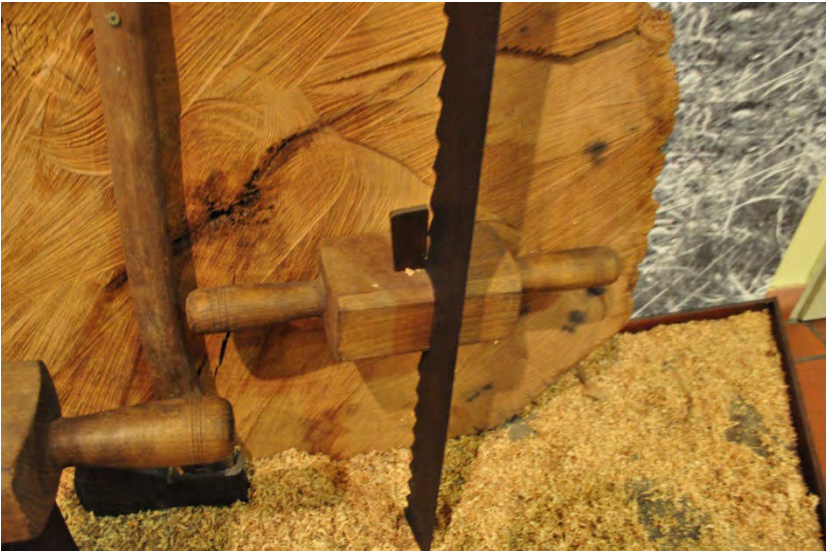
Twee met een wig te bevestigen onderste handvaten van een kraanzaag zonder raam.
