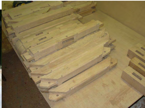
Kerststal, gebouwd in 1991 met kinderen van MPI Ritmica in Hove. De vakwerkconstructie bestaat uit tamme kastanje en de pen-gat verbindingen zijn opgesloten met toognagels.
