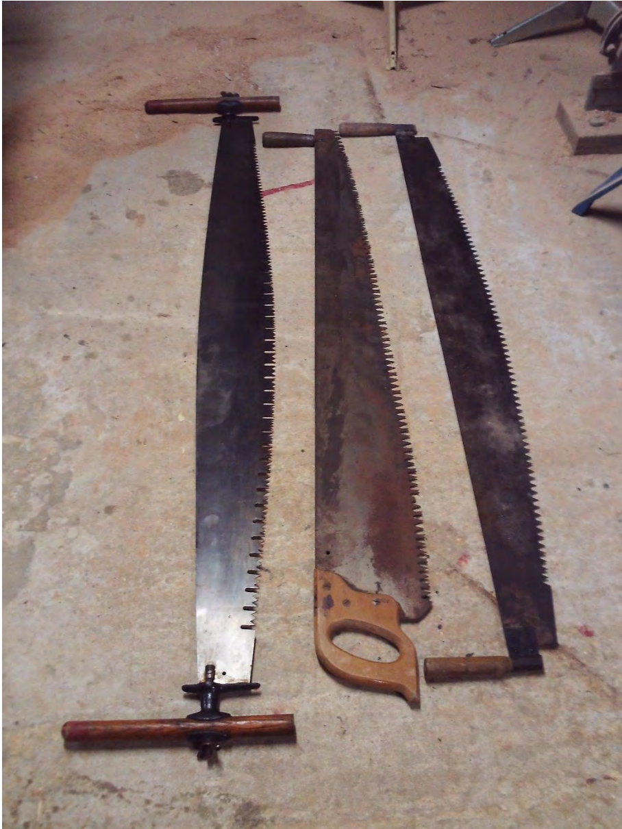
Drie afkortzagen. De twee linkse zagen zijn Amerikaans en hebben een Amerikaanse vertanding. De rechts zaag is van het type dat frequent bij ons voorkwam. Op die laatste zaag staat geen merknaam, maar vermoedelijk komt die van Remscheid (2023).
