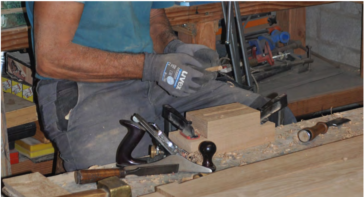
Houten toognagels kan men op verschillende manieren maken. Ik maak ze zoals het beschreven wordt in "Timmeren als ambacht en als hobby" 1980, door Willem Aalders. Maak een houten blok met daarin een langwerpige V-vormige gebeitelde uitsparing. De lengte, breedte en diepte van die uitsparing is in functie
