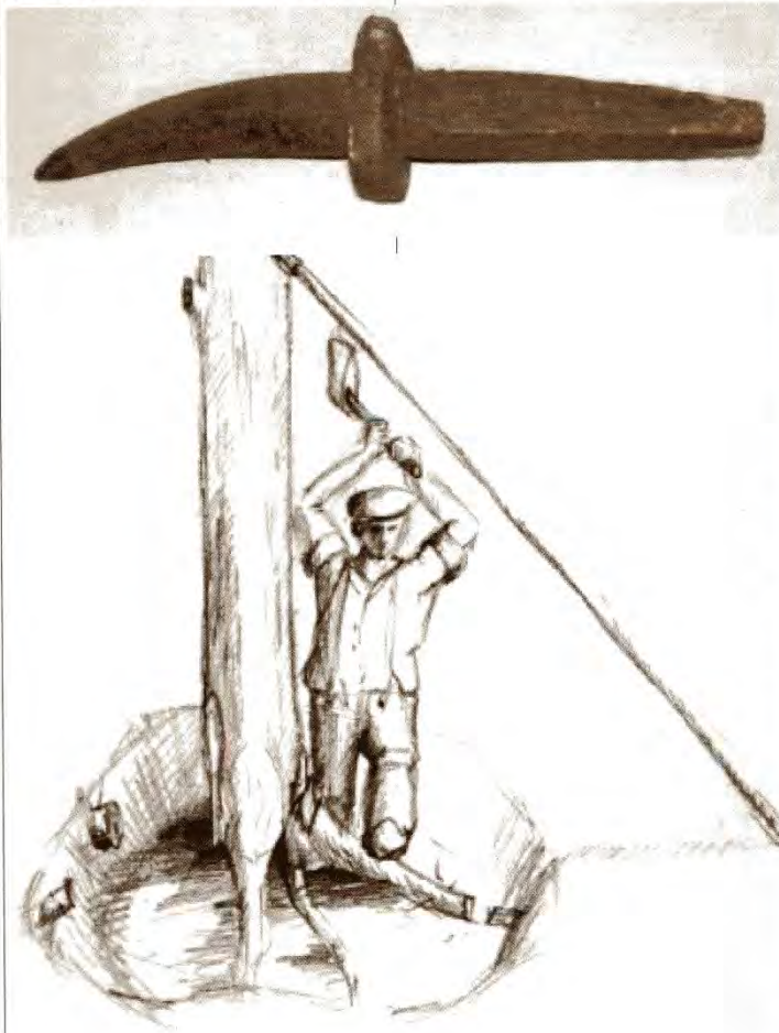
Bovenste deel van een grote boomschoor. Men bemerkt een stuk van het houten deel (= rechte dennestam van ongeveer 12 cm doormeter en 6 meter lengte), de kromme metalen pen en de metalen ring (warm gekrompen op het houten deel).
