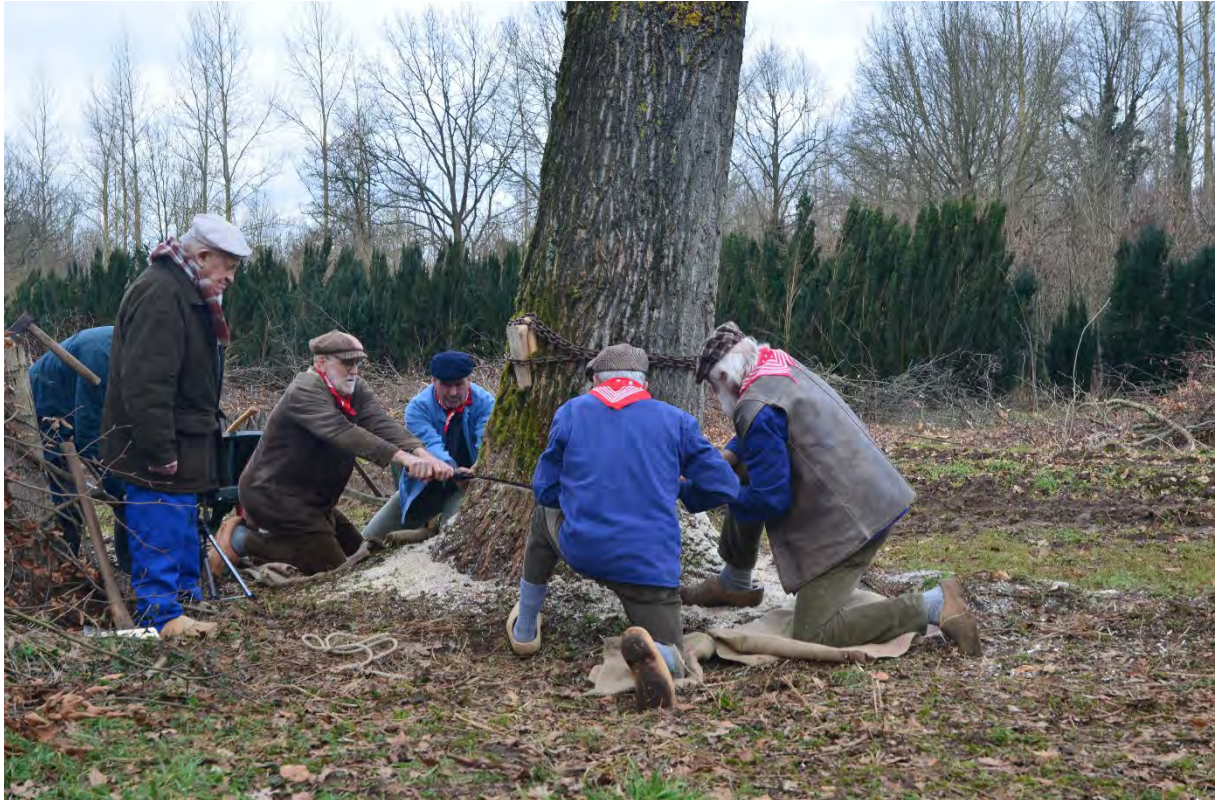
Afzagen van de stam met de afkortzaag. Aan elk handvat trekken er hier twee man. Dit konden er ook meer zijn als men aan elk handvat nog een touw bond. Bemerkt de opwicking van de ketting tegen het scheuren van de stam. Opname van de film "Klompenhout" in 2015. Foto: Paul Van Herck
