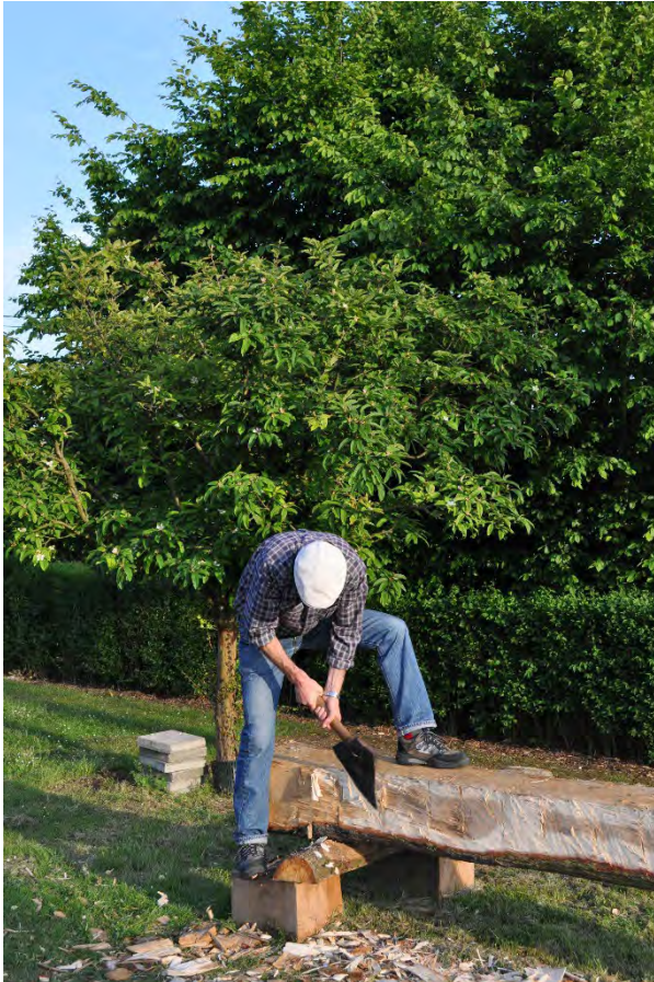
Afwerken van de zijkant met een Duitse beslagbijl of breedbijl (exemplaar voor rechtshandige). Foto's: Danny Huyghens, 2015
