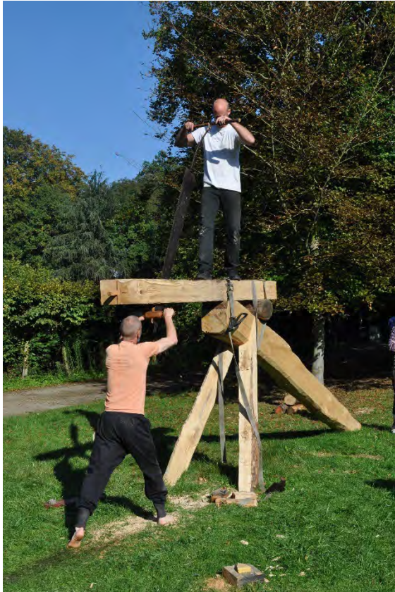
Mathijs (bovenaan) en Ante (beneden). Frans type van zaagbok en met de brede kraanzaag. MOT (Grimbergen), 2015
