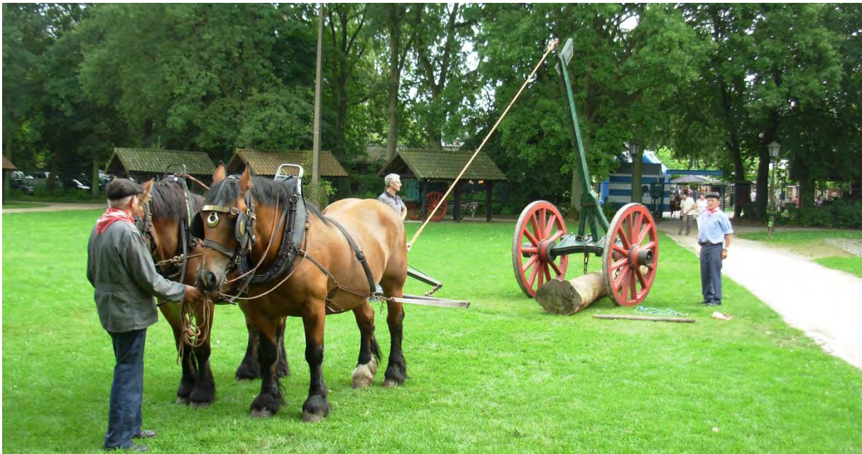
De paarden staan klaar om de dissel van een boomezel omlaag te trekken, waardoor de boom van de grond zal komen. Karrenmuseum Essen, 2009
