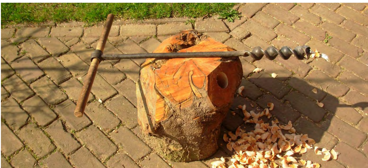
Wortelstronk van een geveld pruimelaar die een kapblok gaat worden. De gaten voor de drie poten in robinia pseudoacacia werden met een avegaar van 2" (51 mm) geboord
