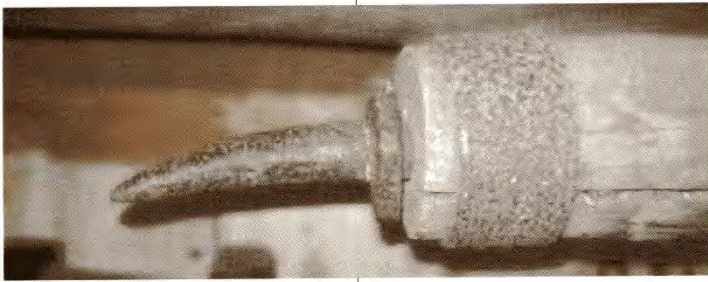
Bovenste deel van een grote boomschoor. Men bemerkt een stuk van het houten deel (= rechte dennestam van ongeveer 12 cm doormeter en 6 meter lengte), de kromme metalen pen en de metalen ring (warm gekrompen op het houten deel).
