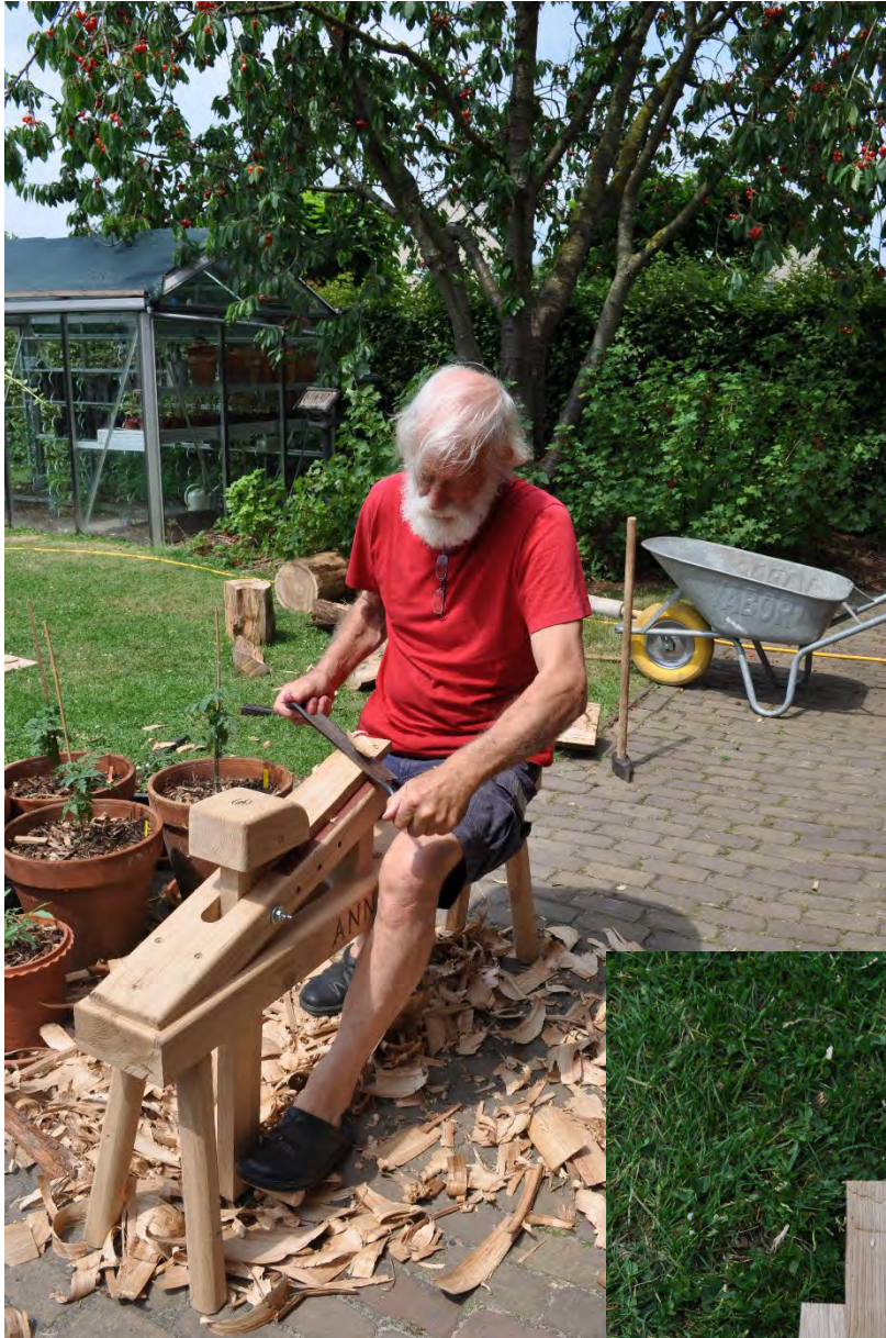
Bijwerken van radiaal gekliefde eiken dakspanen.
