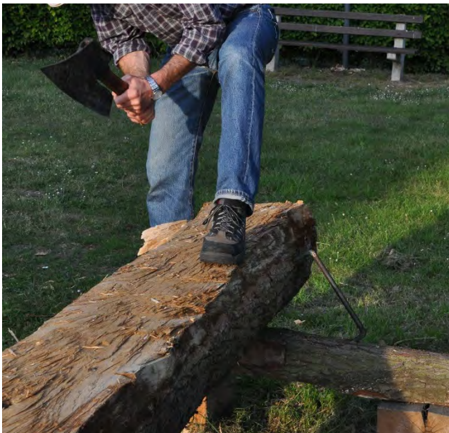
De te bewerken boomstam is aan beide onderliggende balken vast geslagen met een u-vormige haak.
