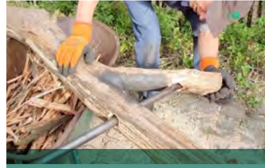
De as wordt mooi door beide asgaten gedreven en staat horizontaal ten opzichte van het maaiveld. (Foto Voorkempen.)
